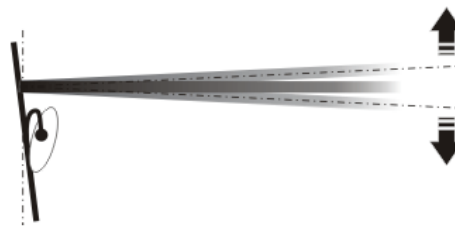
Gambar 2. 19 Penyetelan Kerataan (Vertical Rim)
