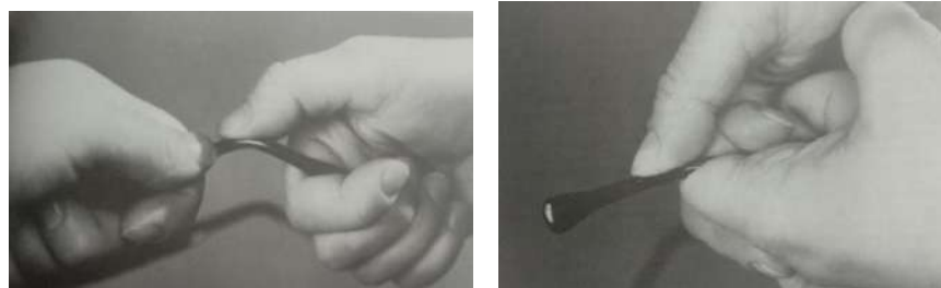
Gambar 2. 25 Penyetelan Ujung Kacamata
